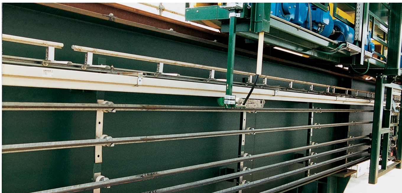
● Антенные направляющие SMG-RAE-XY-6 на большом кране.
