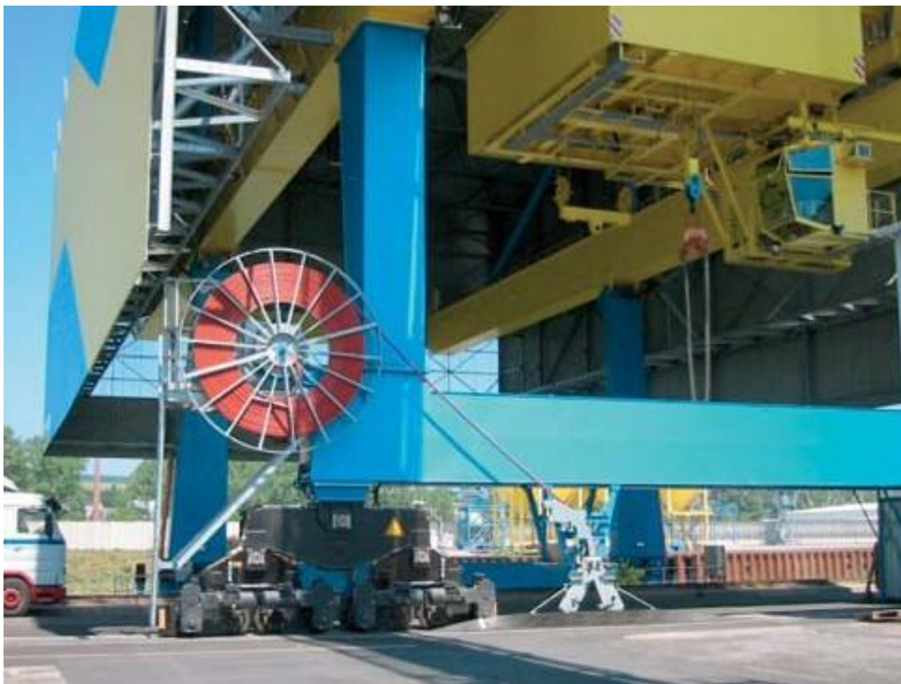
Кабельный барабан с электроприводом LTM 18/38 H4K240-108/МК 78-В на комбинированном кране в порту Andernach, используемый для намотки кабеля 20 кВ. Приведение в действие посредством двигателя трехфазного тока через электромагнитную муфту
