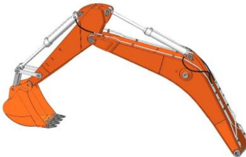
Рабочее оборудование одноковшовых экскаваторов (рукояти и стрелы) представляет собой стальные конструкции коробчатого сечения. Изготавливается из 09Г2С с применением высокопрочных сталей (например Weldom (Швеция)). При изготовлении рабочего оборудования места высоких нагрузок дополнительно усиливаются, так же используются ребра жесткости (внутренние перегородки), что обеспечивает большую жесткость конструкции на изгиб. Основные виды рабочего оборудования:
