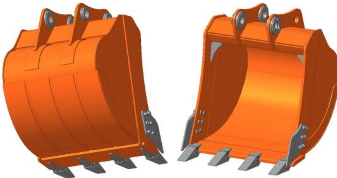
Ковш общего назначения. Используется для всех видов стандартных экскаваторных работ по извлечению неабразивного, редкокаменистого грунта плотностью до 1800 гм/м<sup>3</sup> (песок, суглинок, щебень и прочие), погрузка мелкофракционных сыпучих материалов.
