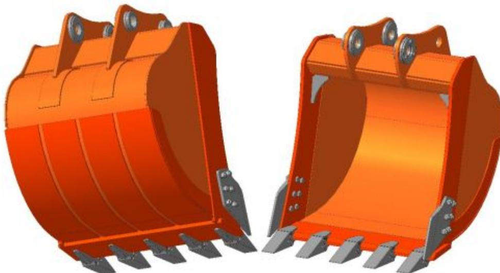
Усиленные ковши предназначены для работы с тяжелыми глинистыми грунтами с небольшим содержанием каменных пород (меловые породы, сланцы и т.д.). Данный тип ковшей используется для **разработки грунтов плотностью до 2000 кг/м<sup>3</sup>**. При изготовлении усиленного ковша, большое количество его элементов изготавливается из износостойких сталей (нож, щеки).
